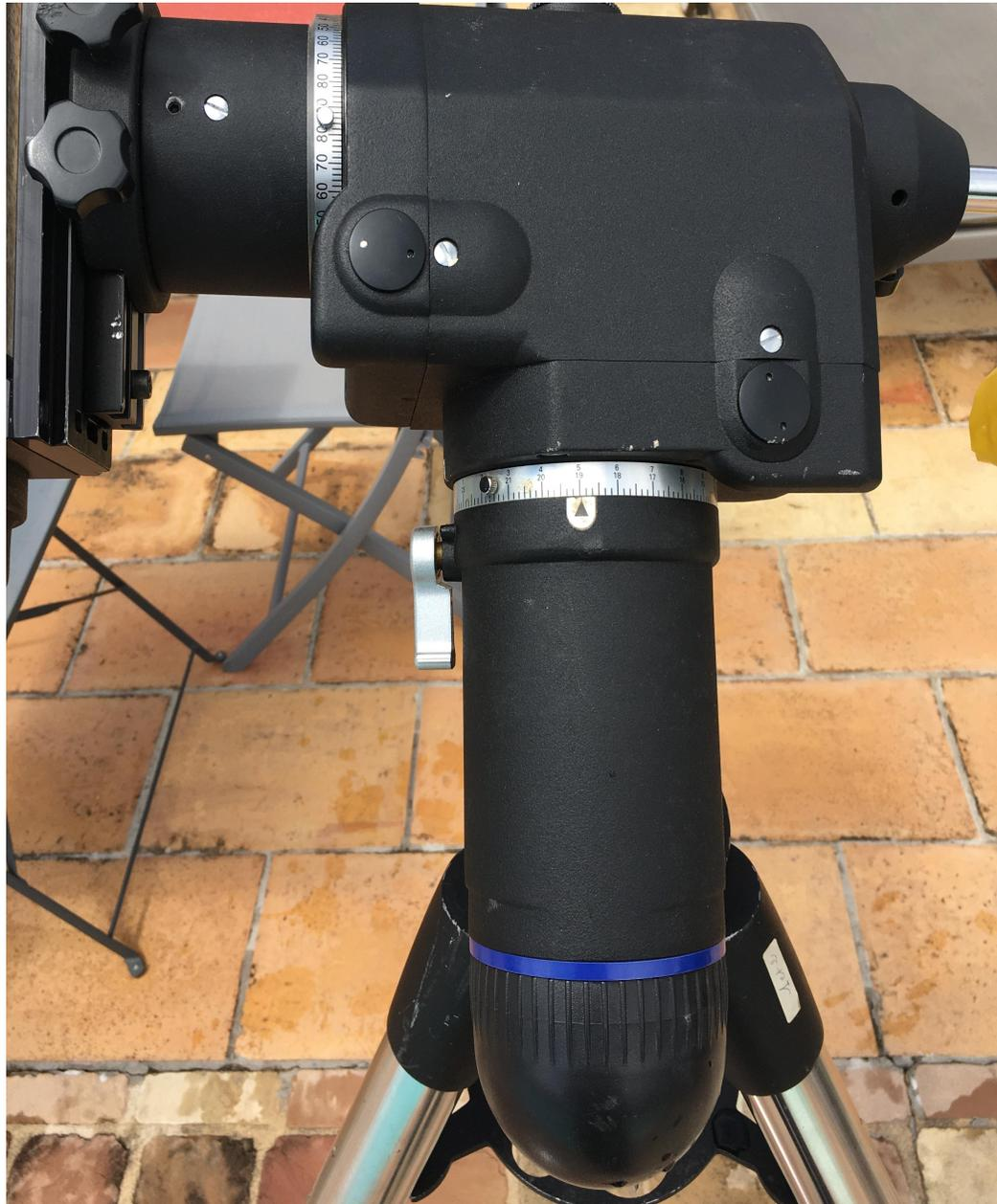
Enfin il ne reste plus qu'à placer la polaire dans le petit rond du viseur avec les vis de latitude et azimuth
