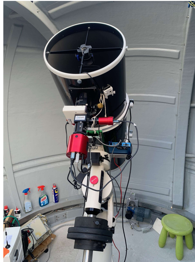
Newton SW 300/1200 Monture Astro-Physics Spectrographe Alpy 200 Ordinateur « Science » avec Prism
